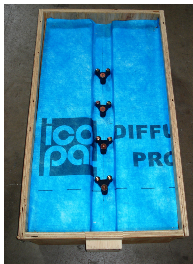
Figura 2.2 – Vista di un campione prima del getto del calcestruzzo (1H 150A).
