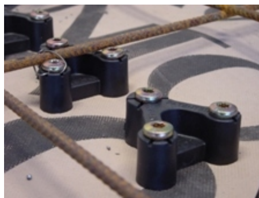
Figura 2.10 – Vista di un campione prima del getto del calcestruzzo.
